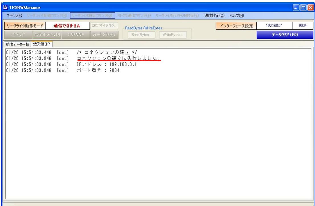
リーダライタの内部で LAN/F ボード側の通信速度とリーダライタモジュール側の通信速度の設定が異なっている場合には、次の画面のように表示されます。
