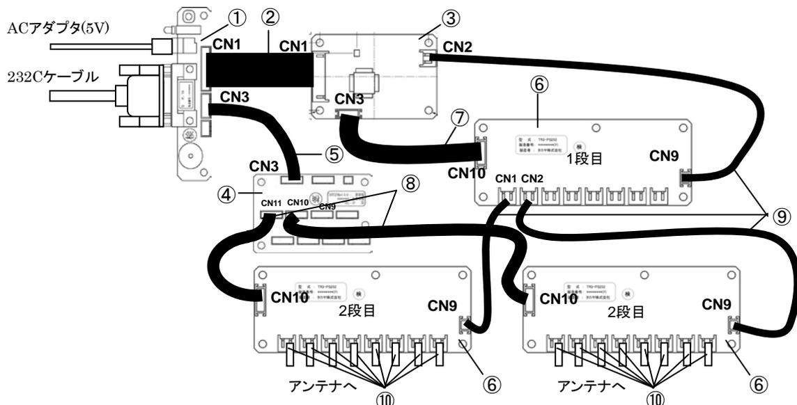
■ 結線情報 (カスケード接続/TR3-IF-1C+TR3-C202/中継基板有り)
