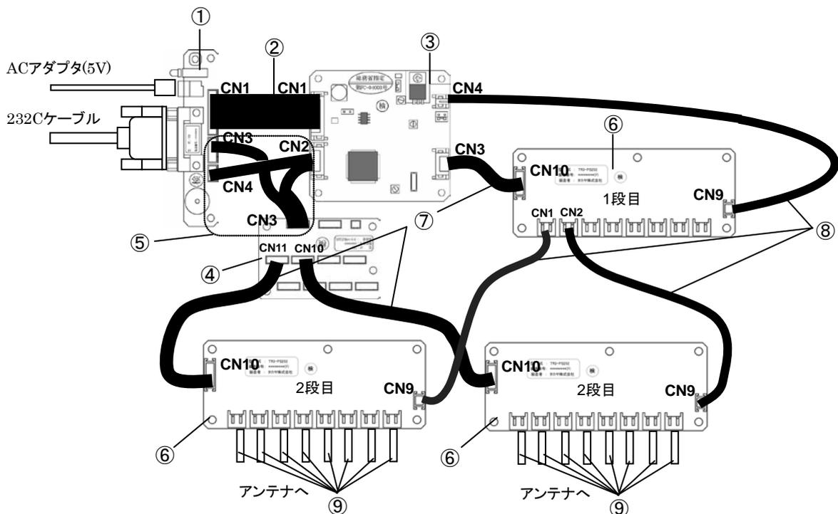
■ 結線情報 (カスケード接続/TR3-IF-1C+TR3-L301[拡張ポート]/中継基板有り)
