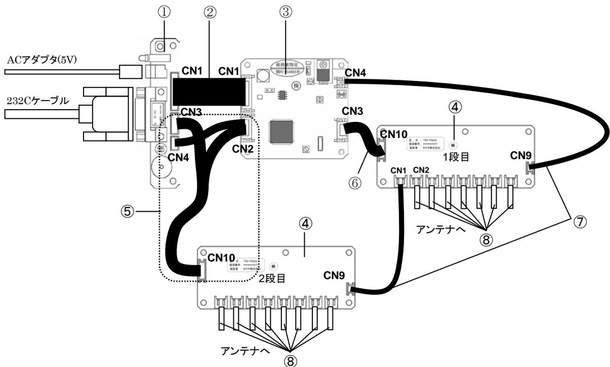
■ 結線情報 (カスケード接続/TR3-IF-1C+TR3-L301[拡張ポート]/中継基板無し)
