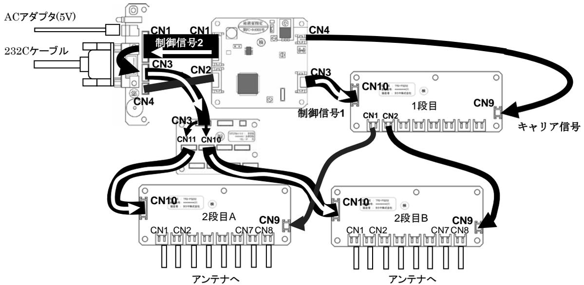
リーダライタモジュールからの制御信号は制御信号 1 と、制御信号 2 になります。制御信号 1 は 1 段目のアンテナ切替基板を制御し、制御信号 2 は 2 段目のアンテナ切替基板を制御します。リーダライタの CN4 から出力されるキャリア信号は 1 段目のアンテナ切替基板の CN9 に入力されます。入力されたキャリア信号は制御信号 1 により 2 段目のアンテナ切替基板へ出力されます。2 段目のアンテナ切替基板に入力されたキャリア信号は制御信号 2 により各基板の CN1～CN8 へ切り替えながら出力されます。
