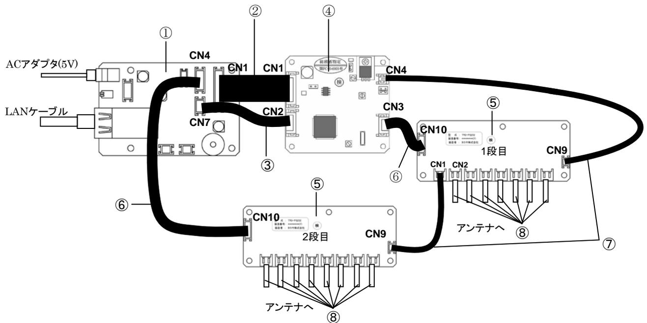
■ 結線情報 (カスケード接続/TR3-IF-N4+TR3-L301[通常ポート]/中継基板無し)
