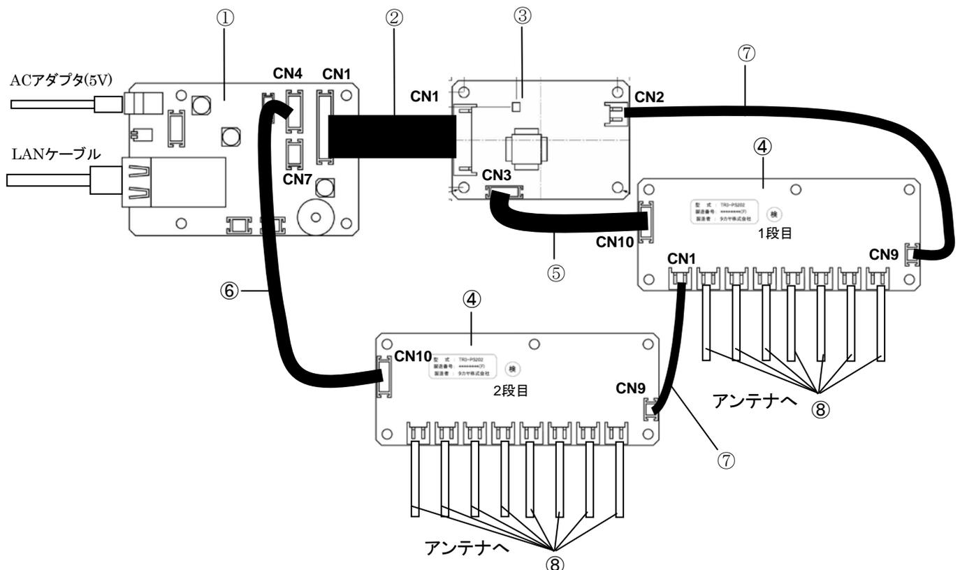
■ 結線情報 (カスケード接続/TR3-IF-N4+TR3-C202/中継基板無し)
