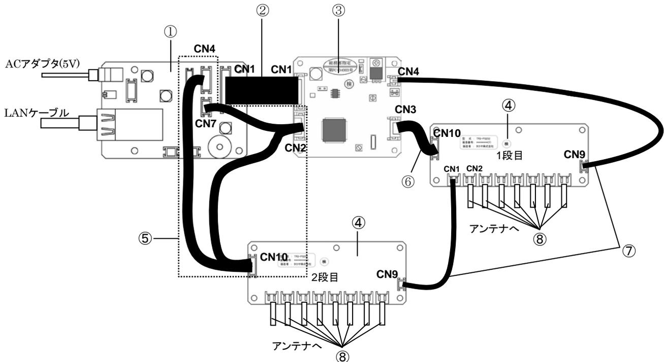
■ 結線情報 (カスケード接続/TR3-IF-N4+TR3-L301[拡張ポート]/中継基板無し)
