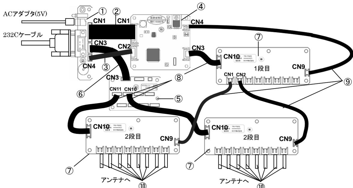
■ 結線情報 (カスケード接続/TR3-IF-1C+TR3-L301[通常ポート]/中継基板有り)
