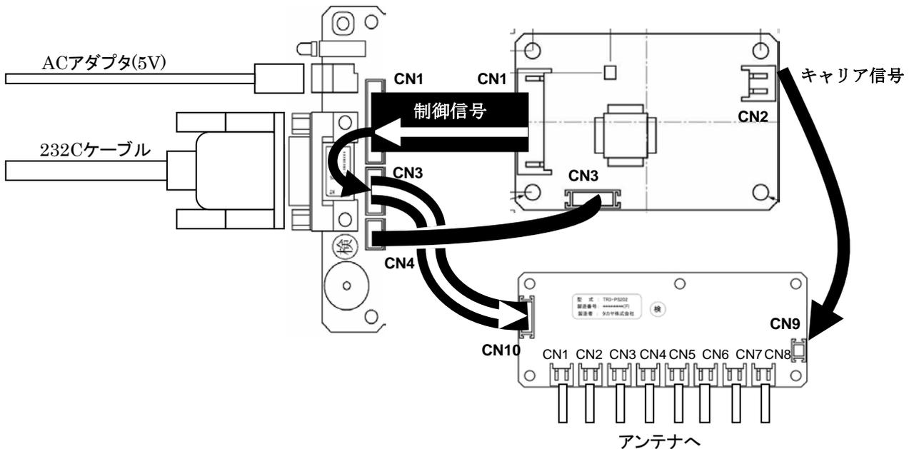
リーダライタモジュールからの制御信号はインターフェース基板を經由して、アンテナ切替基板の CN10 に入力されます。リーダライタの CN2 から出力されるキャリア信号はアンテナ切替基板の CN9 に入力されます。入力されたキャリア信号はアンテナ切替基板に入力された制御信号により CN1～CN8 へ切り替えながら出力されます。
