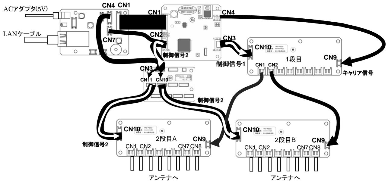
リーダライタモジュールからの制御信号は制御信号 1 と、制御信号 2 になります。制御信号 1 は 1 段目のアンテナ切替基板を制御し、制御信号 2 は 2 段目のアンテナ切替基板を制御します。
