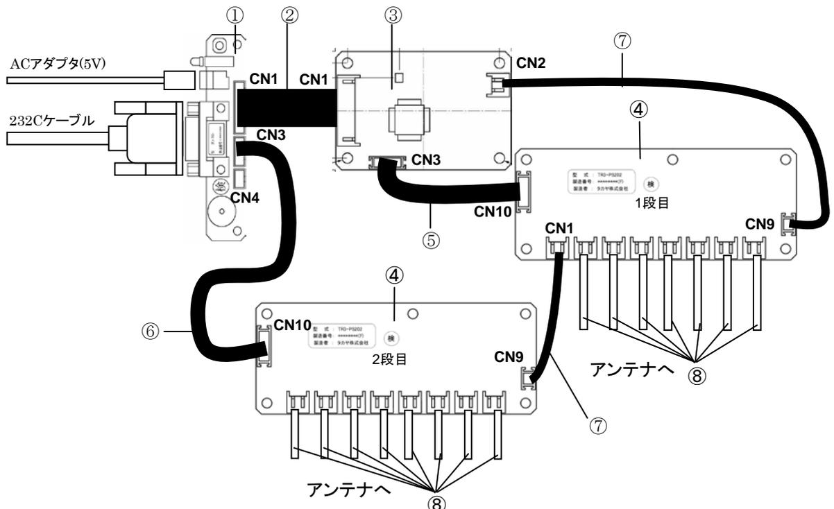
■ 結線情報 (カスケード接続/TR3-IF-1C+TR3-C202/中継基板無し)
