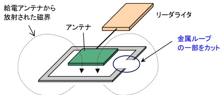
金属の一部をカットして、誘導電流または渦電流がループ状に流れなければ、逆位相の磁界は発生せず、性能への影響は少ない。
