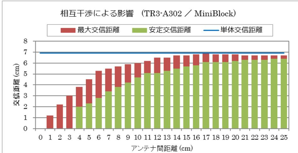
● ASK変調 / RFタグ：MB89R119B コイン型 FRAM (φ30mm)
