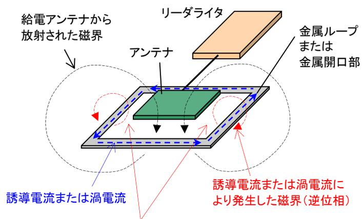
以下のいずれかの状態によりアンテナから放射される磁束を弱めてしまう場合がある。
