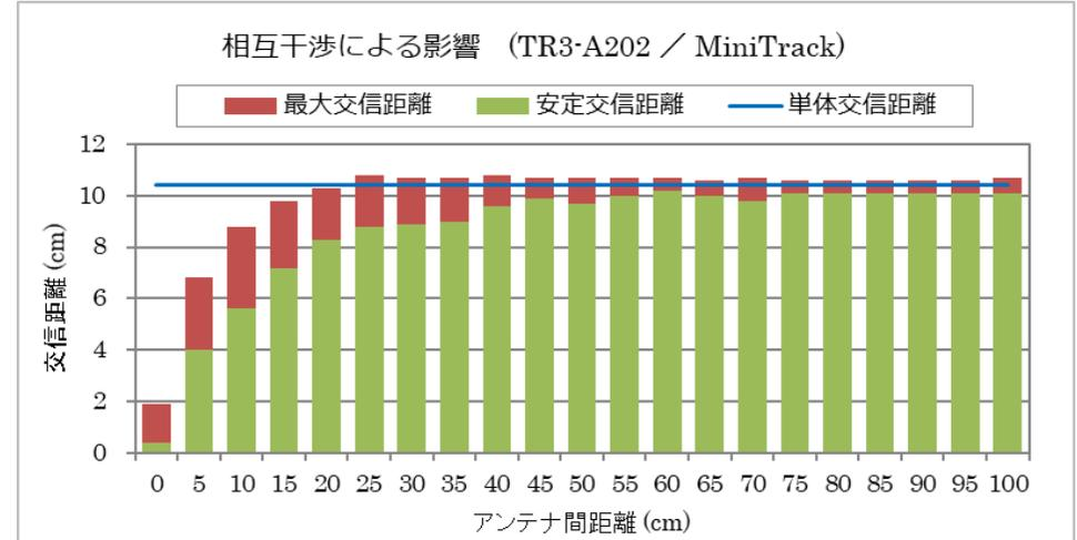
● FSK変調 / RFタグ：SLIXラベルタグ MiniBlock (14.5×14.5mm)
