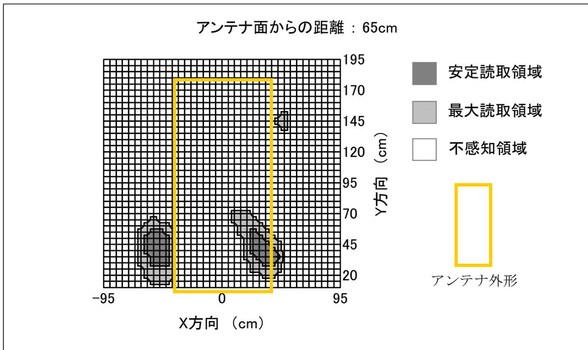
対象アンテナ：ゲートタイプTR3-G003(外形：1756×784mm)
