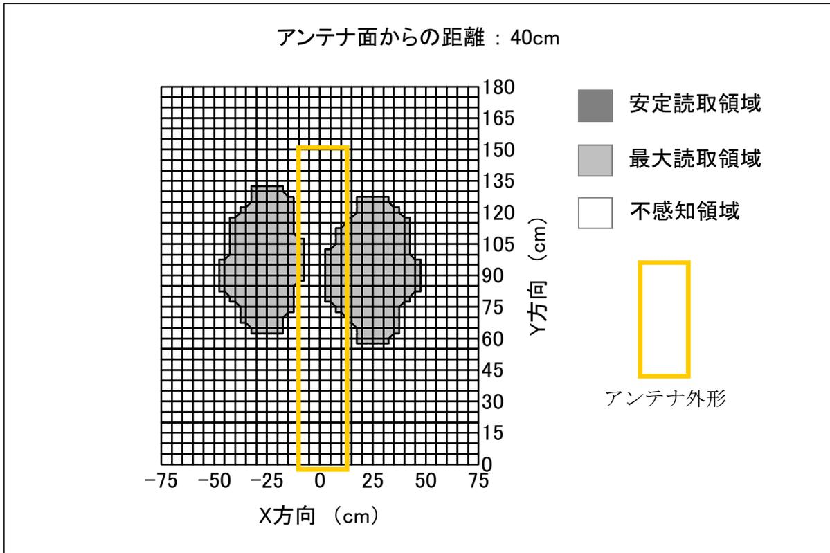
対象アンテナ：ゲートタイプTR3-G001B／アンテナ部外形：895×270mm
