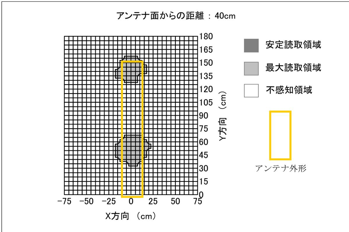
対象アンテナ：ゲートタイプTR3-G003(外形：1756×784mm)
